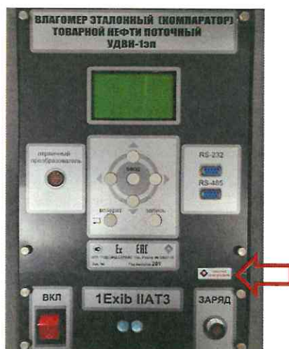
Рисунок 2 – Место пломбирования влагомера
