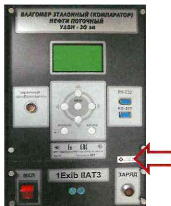
Рисунок 2 – Место пломбирования влагомера
