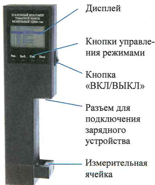
Рисунок 1 – Общий вид влагомера
