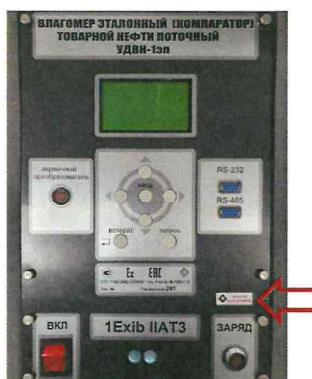
Рисунок 2 – Место пломбирования влагомера
