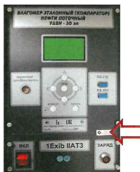
Рисунок 2 – Место пломбирования влагомера
