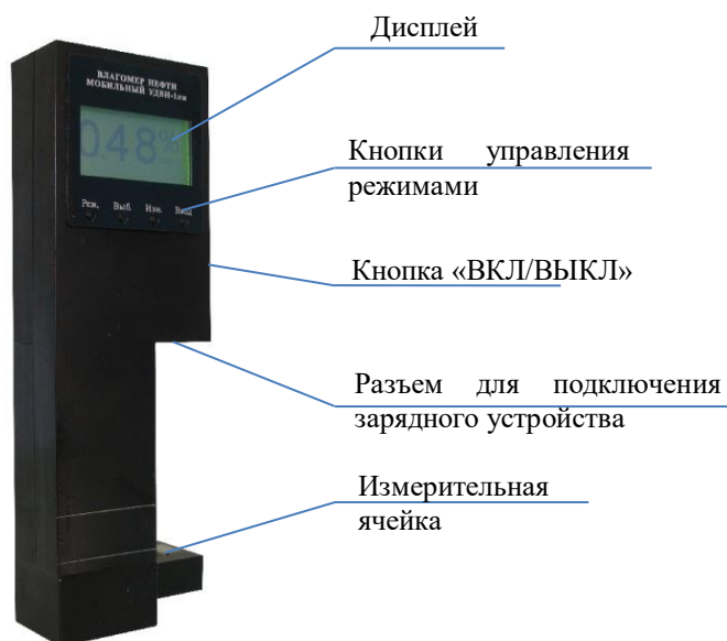
Рисунок 1 – Внешний вид влагомера нефти мобильного УДВН-1лм
